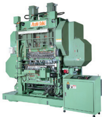
▲iTP-60 主に円筒型電池缶の「2170」サイズの製造用として使用されています。
