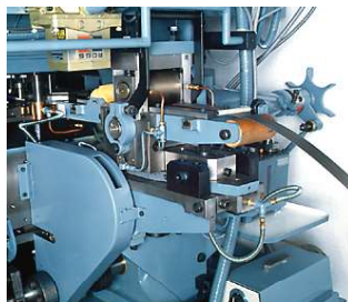
■オシレーティングフィード装置 材料をジグザグに送るのに使用し、2列採り、3列採りがあります。
