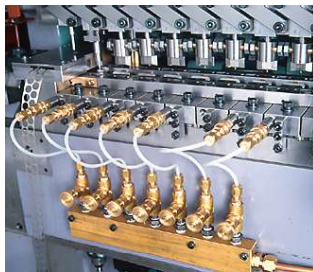
■オイル潤滑装置 ダイ及び材料に加工油を供給するのに使用します。
